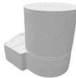
Фантом для геометрической калибровки системы трехмерной съемки
